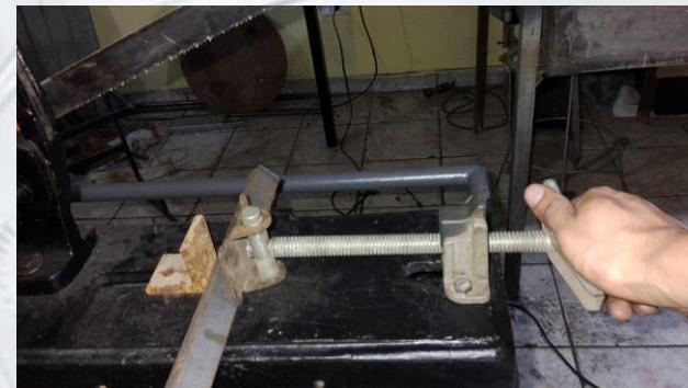
➤ 3º Passo - Ligar a máquina, descer a lâmina cuidadosamente até encostar no material e iniciar o corte;
