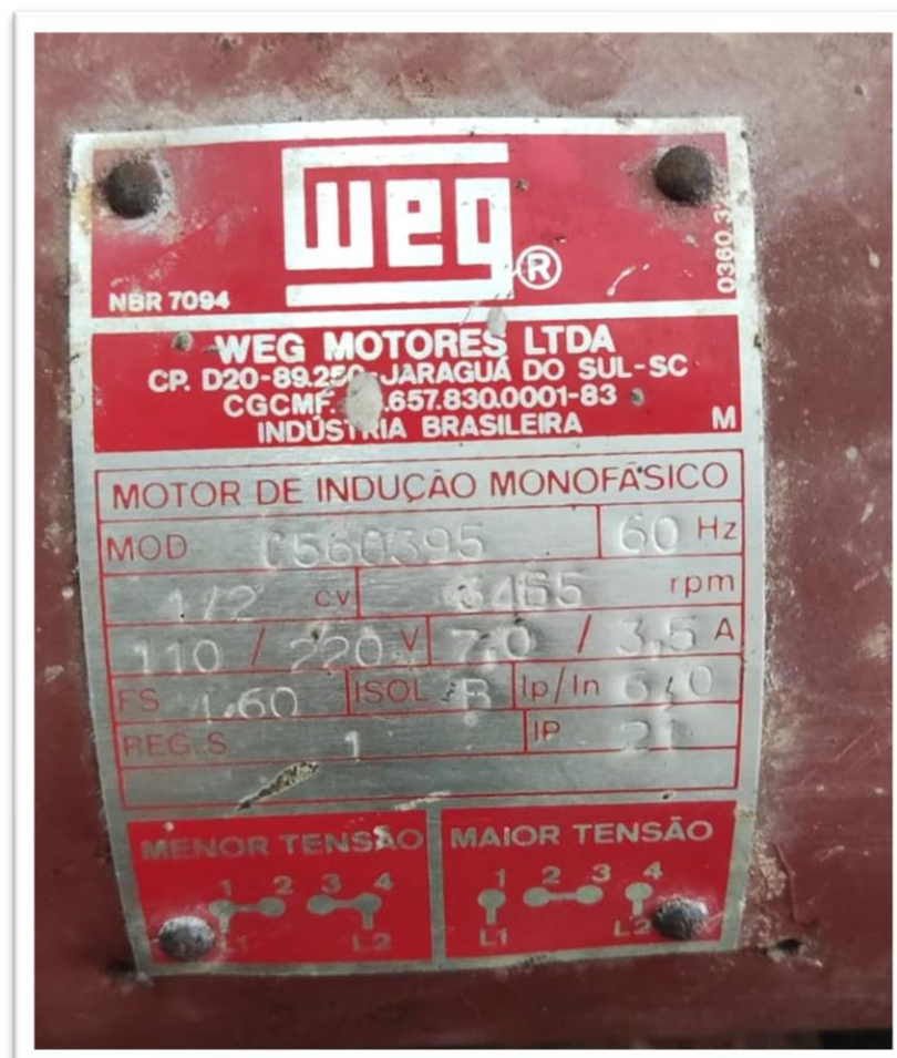
Figura 24 - Placa de especificações técnicas do motor
