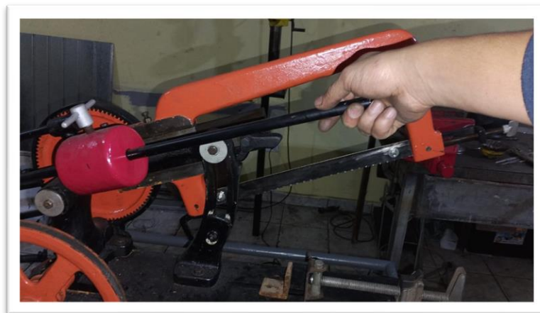
Figura 29 - Descer a lâmina
