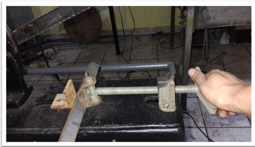
Figura 27 - Posicionar e fixar na morsa
