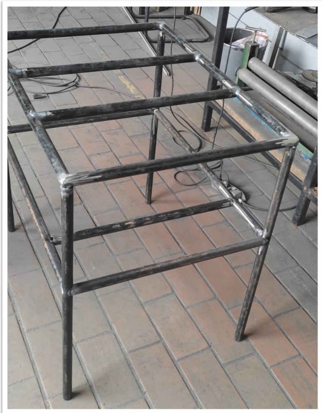
Figura 18 - Estrutura da bancada aguardando tampo e pintura
