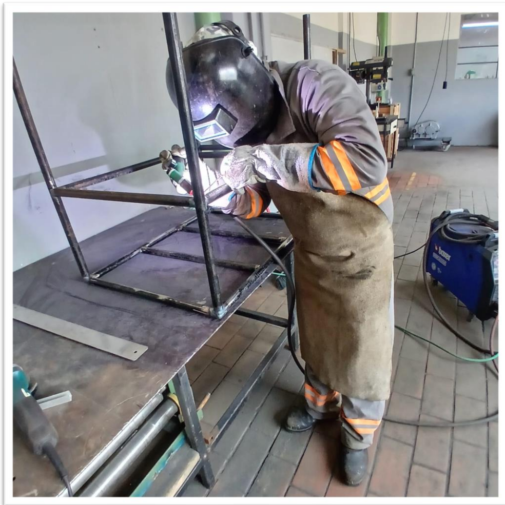
Figura 17 - Processo de fabricação da bancada, solda tig, com gás argônio
