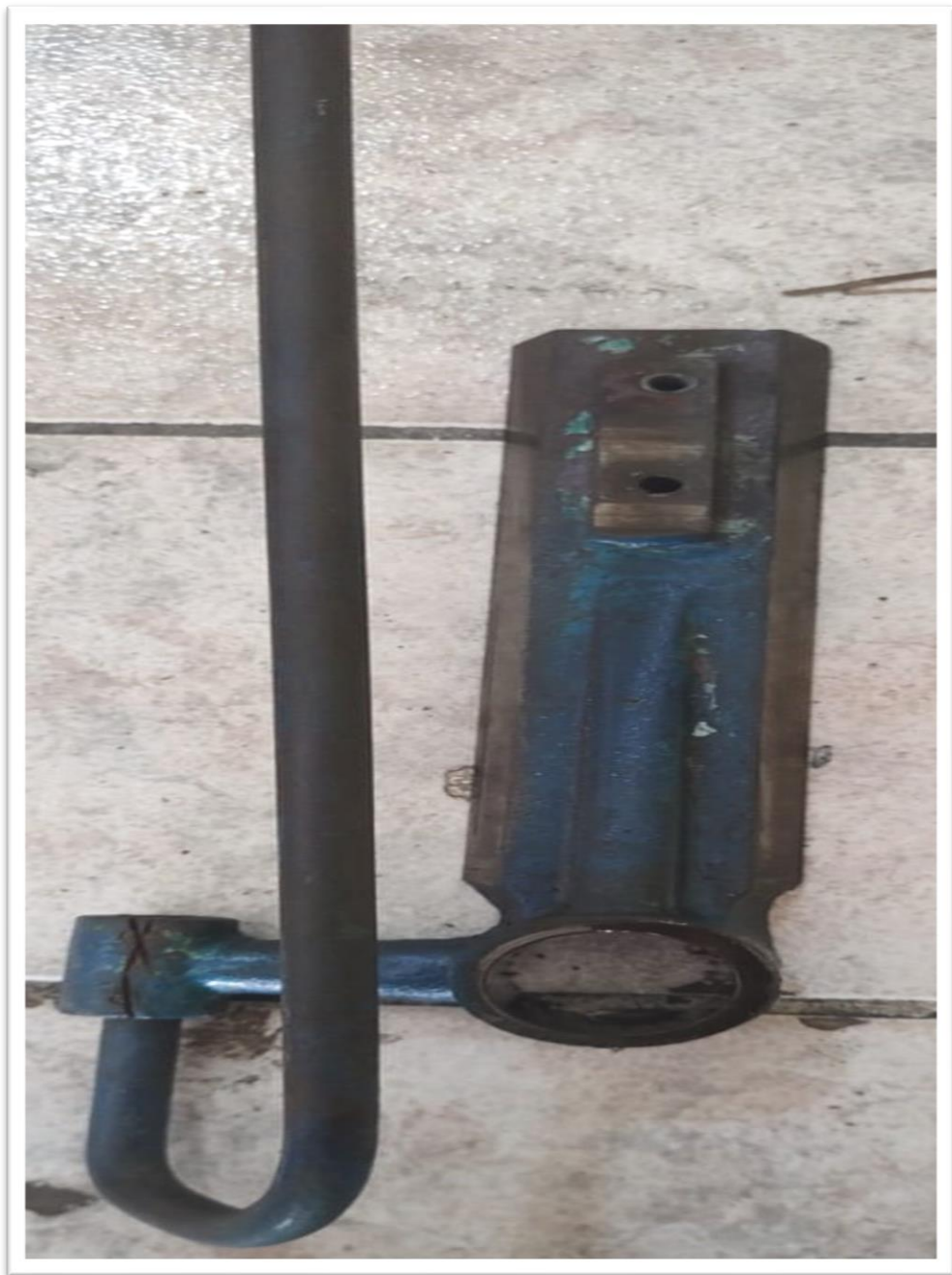
Figura 10 - Braço do contrapeso e guia linear da serra
