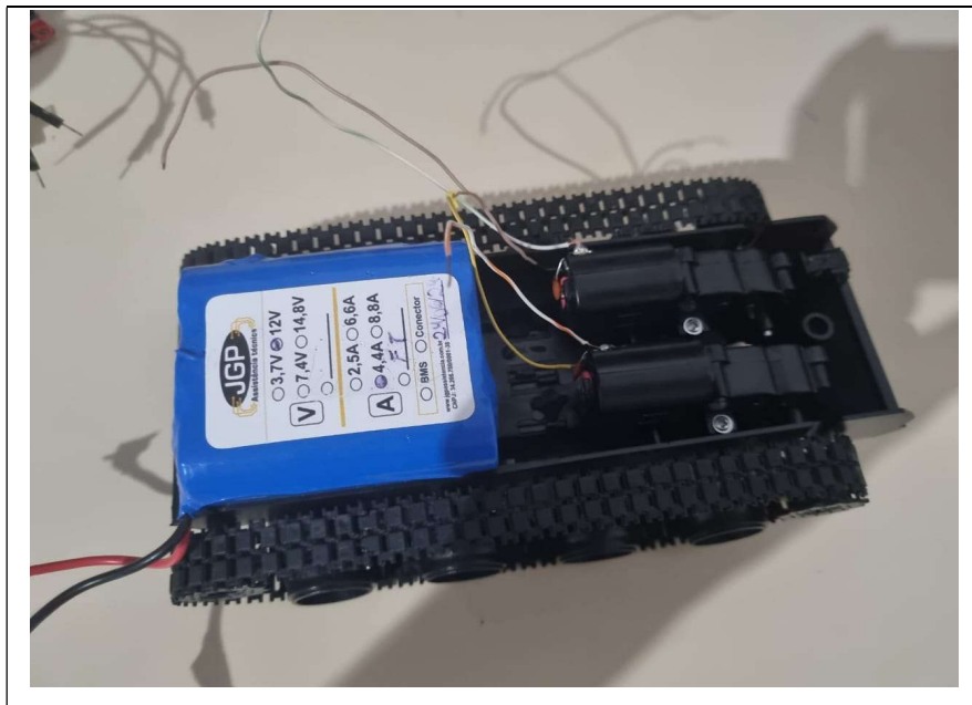
Figura 13 – Instalação da bateria no chassi FONTE: Elaborado pelos autores (2024).
