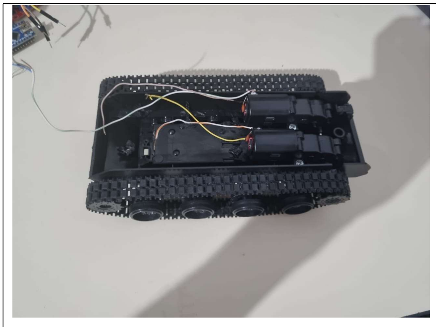
Figura 11 – Instalação das rodas e motores no chassi FONTE: Elaborado pelos autores (2024).
