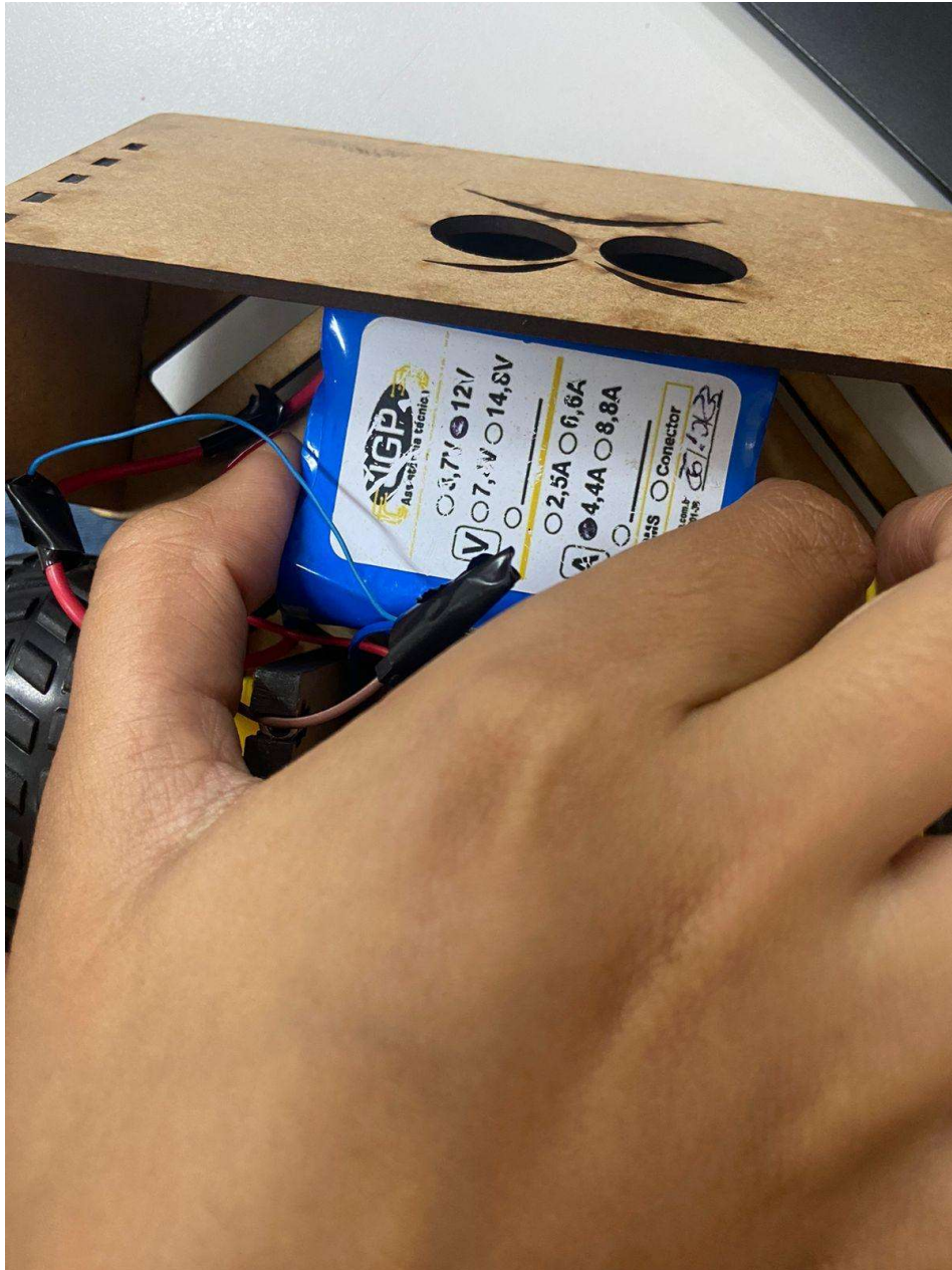
Figura 14 – Instalação da bateria no chassi FONTE: Elaborado pelos autores (2024).
