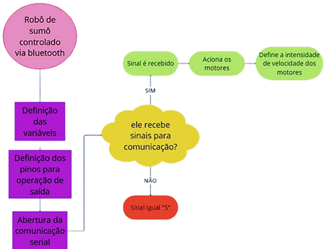
Figura 15 – Fluxograma do programa do robô. FONTE: Elaborado pelos autores (2024).
