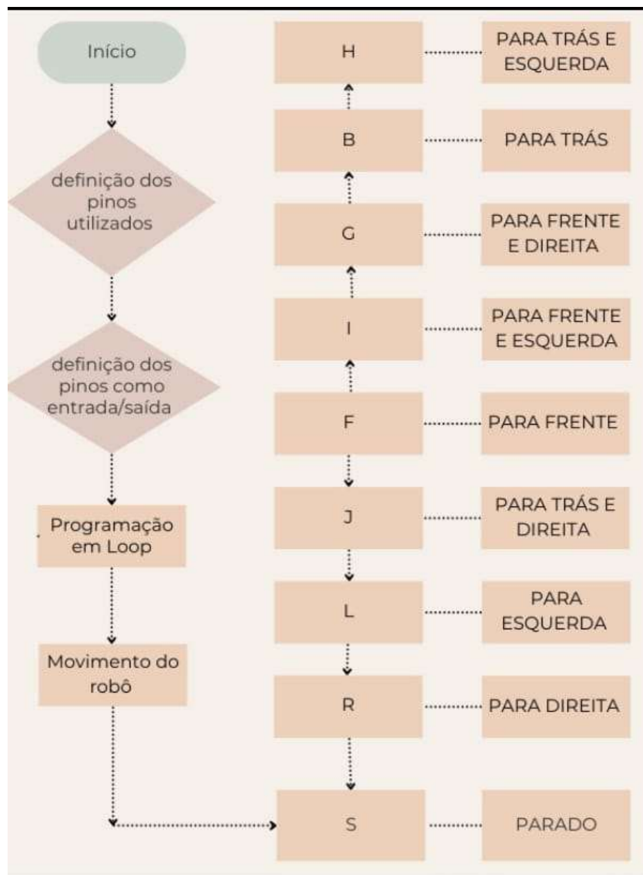
Figura 14 – Fluxograma do programa do robô
