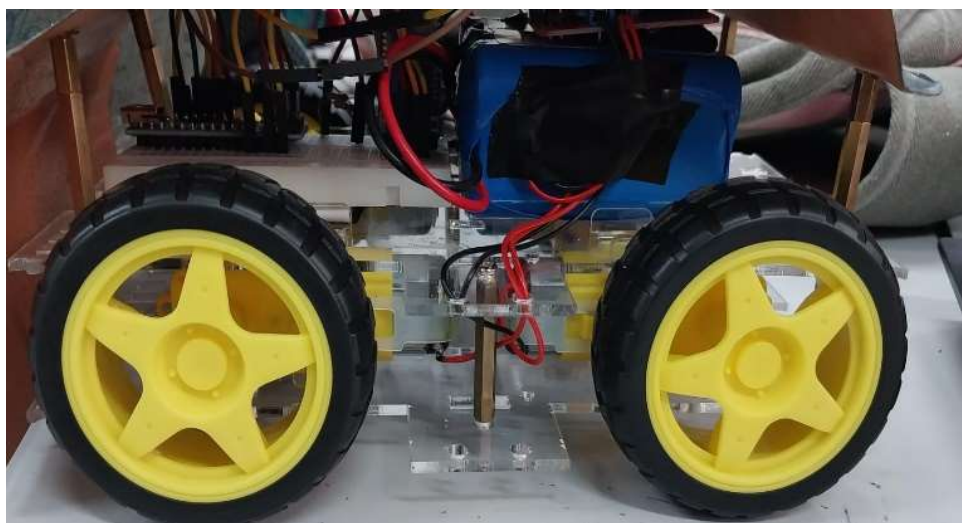
Figura 9 – Instalação das rodas e motores no chassi
