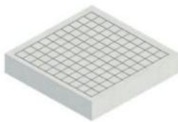
Concreto com Armadura Superior
