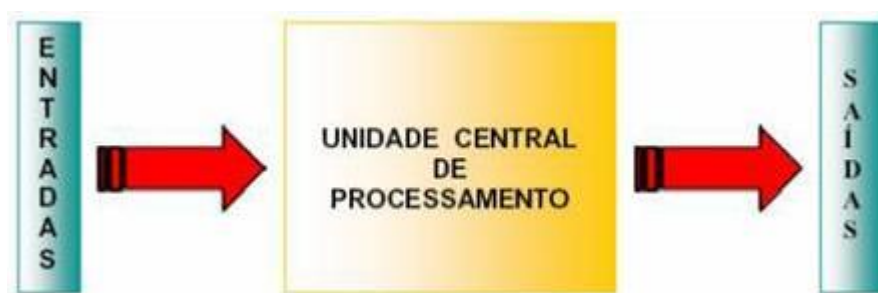
Figura 4: representação das partes que compõe um CLP
