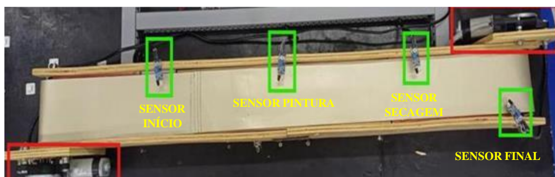
Figura 18: esteira com os motores e sensores
