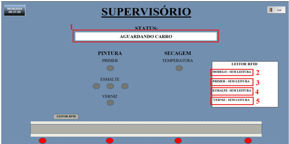
Figura 51: indicação dos blocos de mensagens dinâmicas do supervisor
