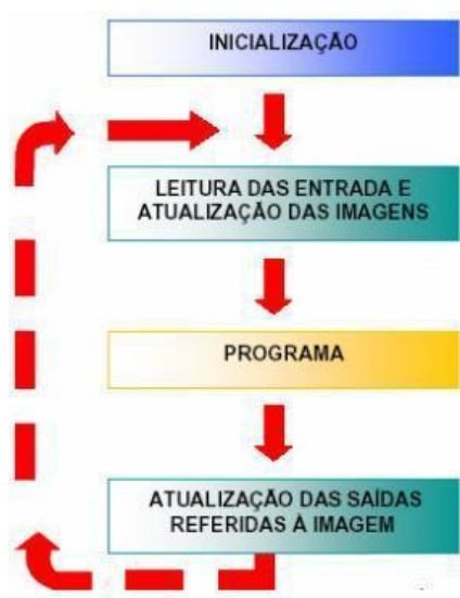
Figura 5: diagrama explicativo do funcionamento do PLC
