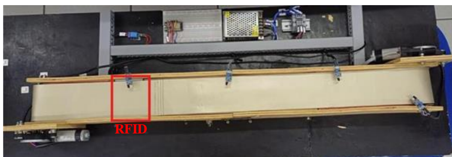
Figura 19: localização do RFID e visão total da parte física do projeto
