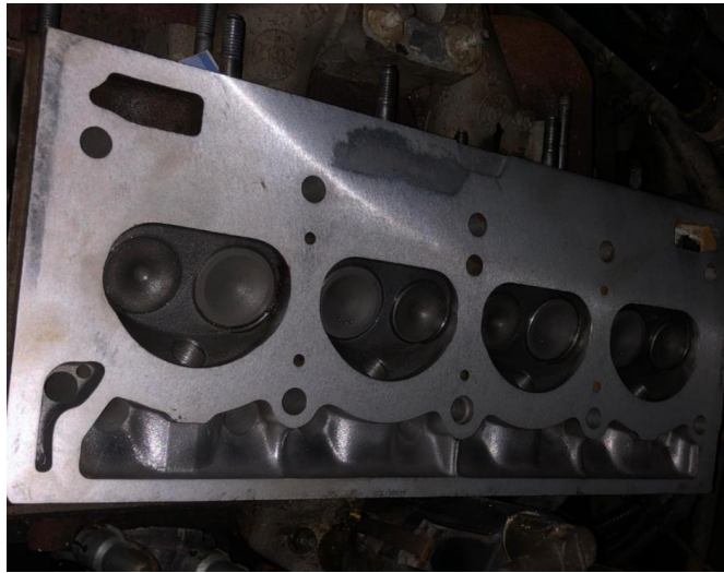
Figura 27: Parte inferior do cabeçote retificada.
