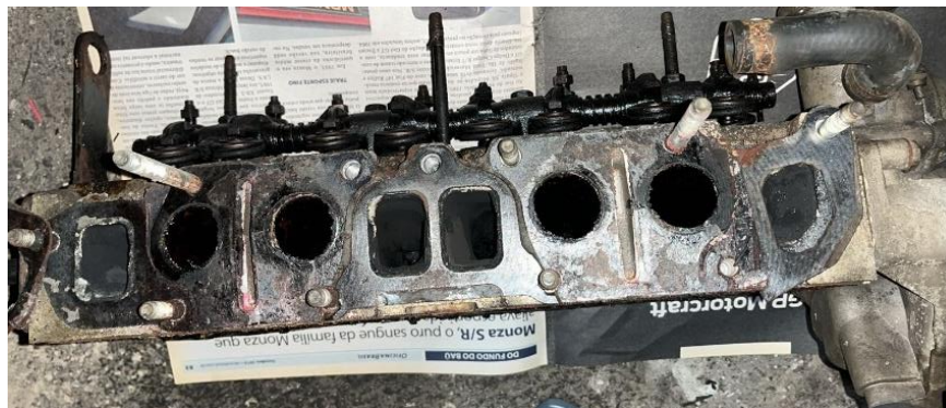
Figura 25: Cabeçote antes de retificar.
