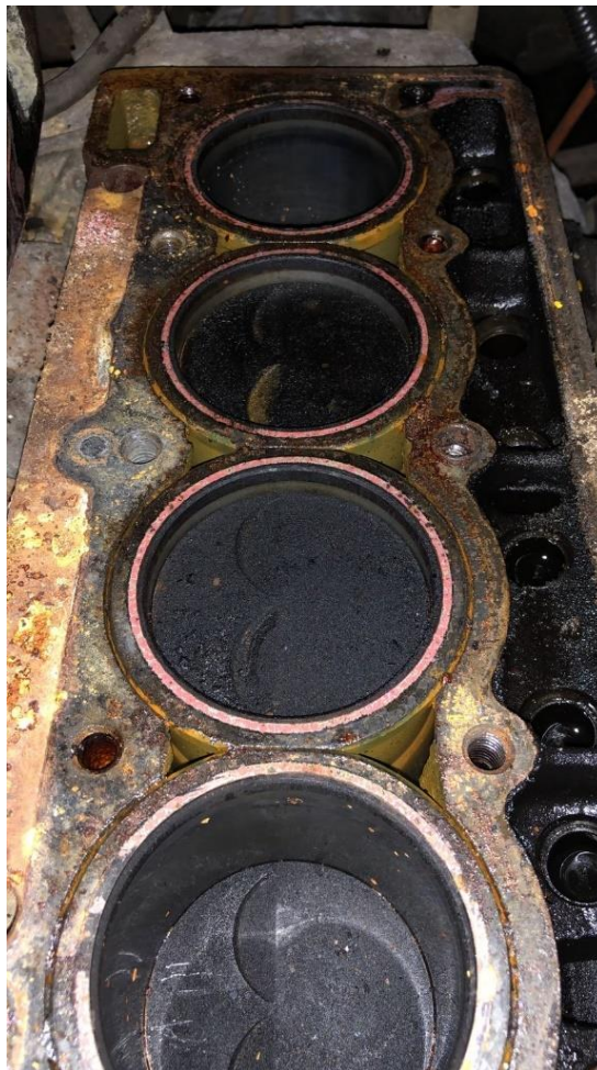
Figura 26: Bloco do motor antes da limpeza.
