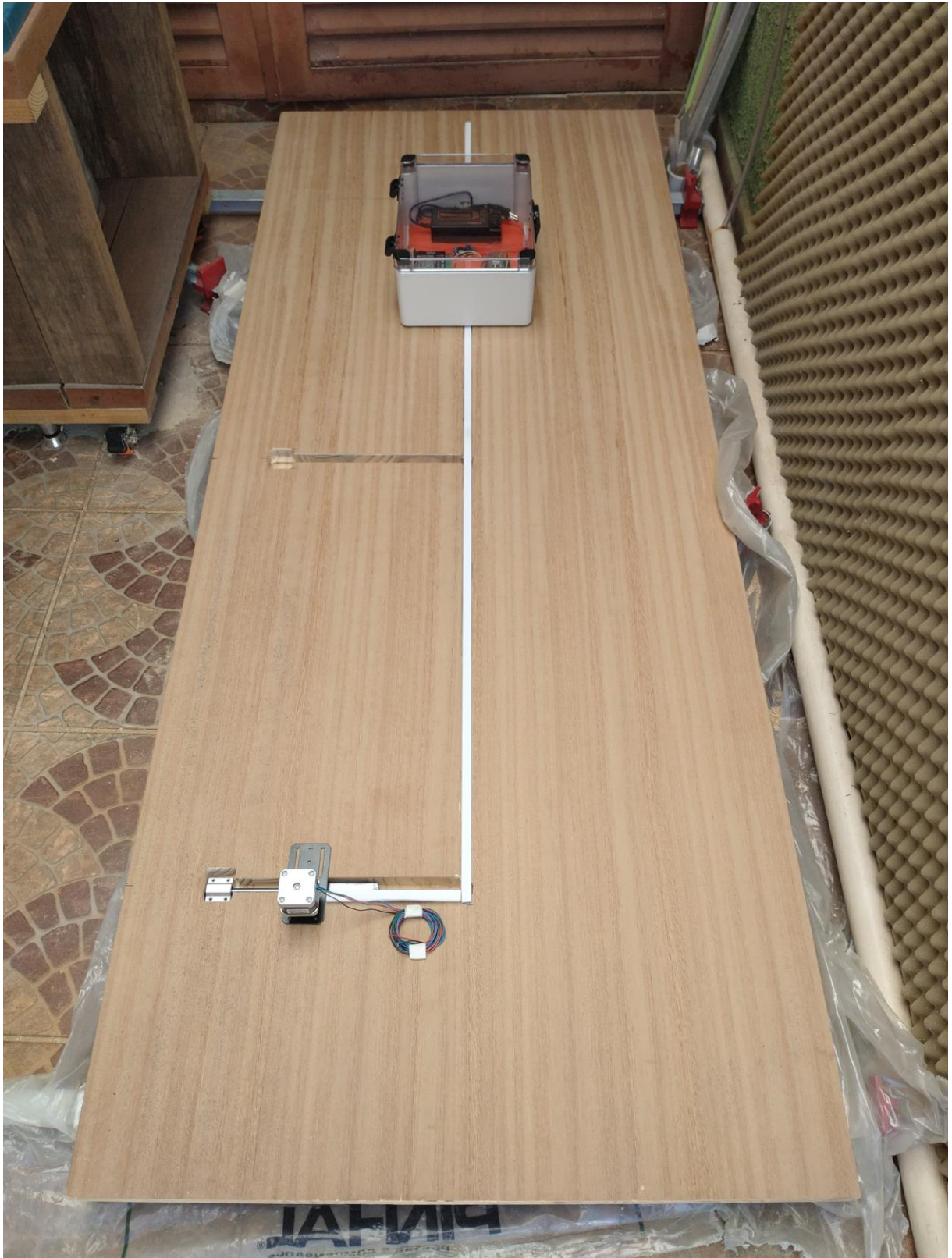
Figura 43 – Detalhe canto inferior esquerdo, iniciando a montagem das travas elétricas, que contém motor de passo (com suporte), engrenagem, cremalheira, eixo linear e pillow block.
