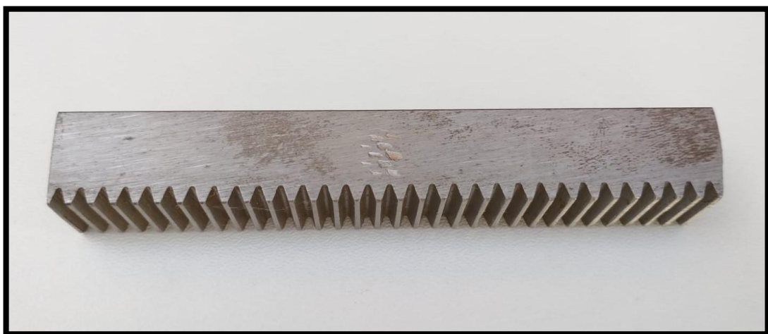
Figura 23 – Cremalheira de aço módulo 1 com 10cm de comprimento
