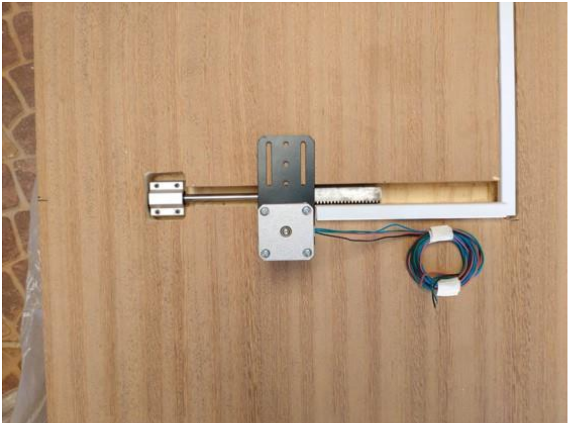
Figura 44 – Detalhe aproximado da montagem das travas elétricas.
