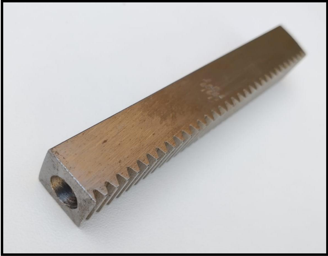
Figura 24 – Cremalheira de aço módulo 1 mostrando o furo de encaixe do eixo linear de 8mm
