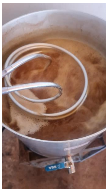
Foto 34 - esterilizando a serpentina.
