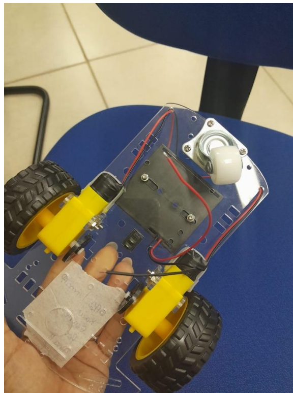
Figura 10 – Instalação da bateria no chassi FONTE: Elaborado pelos autores (2024).
