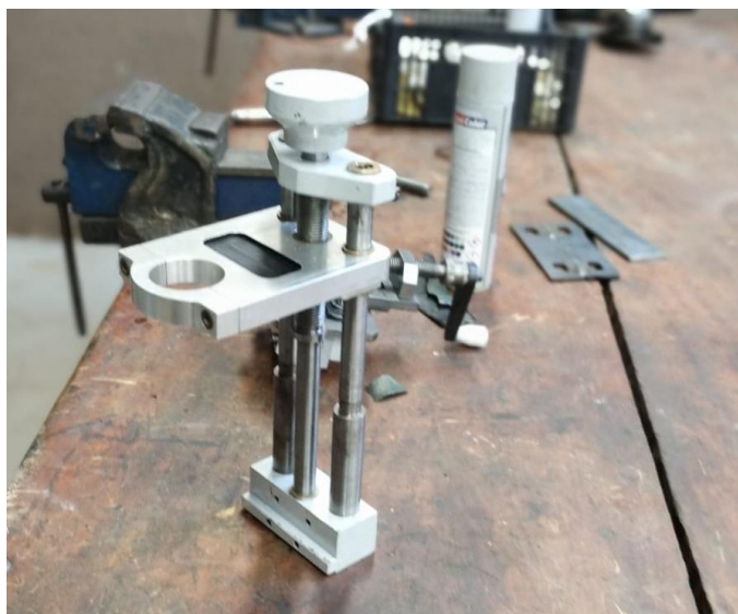
FIGURA 31: Montagem da base vertical.
