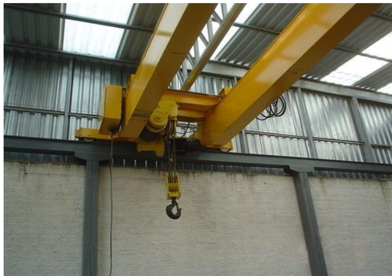
Figura 11: Ponte Rolante Dupla-Viga
