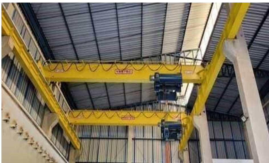
Figura 8: Ponte Rolante Apoiada
