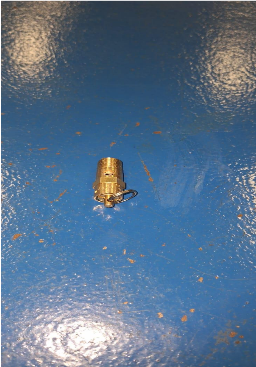
Figura 6 Válvula de segurança Fonte: Arquivo Próprio
