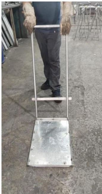
Figura 4 – Estrutura do carrinho montada com haste frontal (Visual geral da base e da estrutura metálica finalizada)
