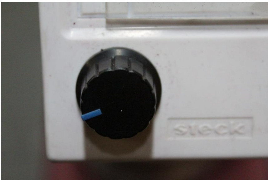
Figura 22 – Regulagem de velocidade via potenciômetro.
