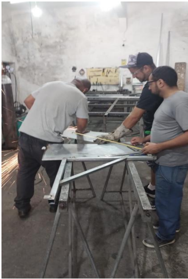
Figura 2 – Corte das chapas metálicas com esmerilhadeira (Registro do processo de corte das peças conforme o planejamento dimensional)
