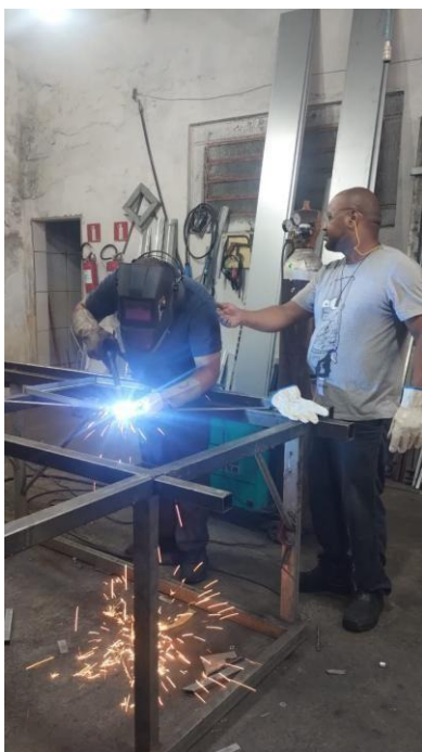
Figura 3 – Processo de soldagem da estrutura do carrinho (Aplicação da solda MIG para união das partes estruturais)
