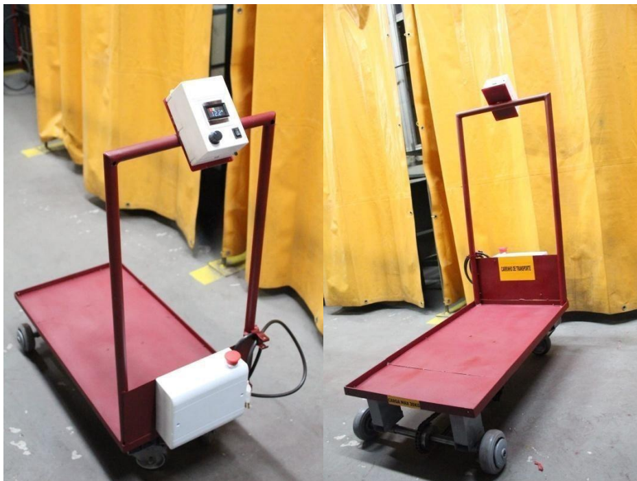
Figura 17 e 18 – Carrinho finalizado com estrutura pintada e sistemas ajustados (Visual do protótipo pronto, com acabamentos aplicados e pronto para testes práticos)
