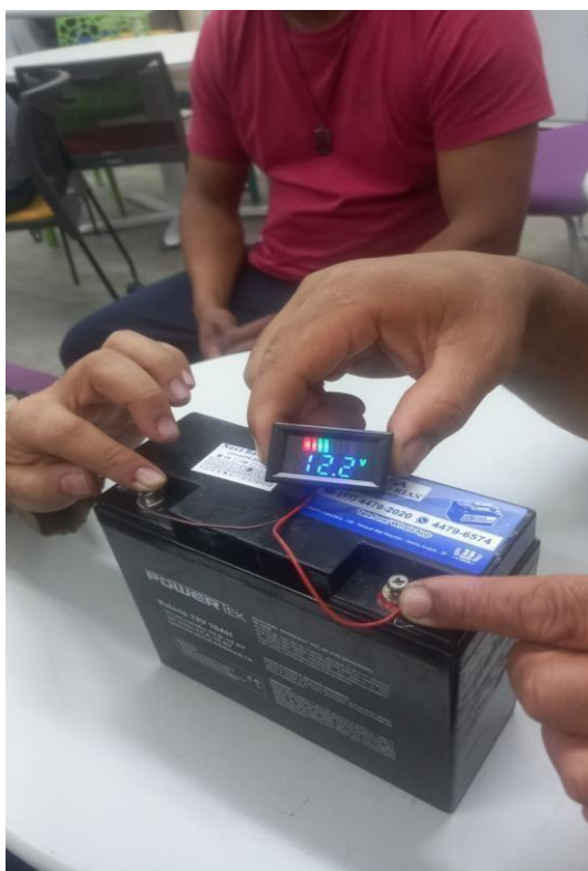
Figura 10 – Display digital ligado a bateria 12V
