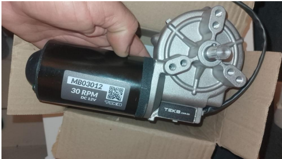
Figura 6 – Motorreductor utilizado no projeto (Modelo fixado na estrutura do carrinho)
