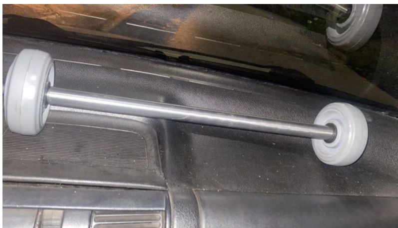
Figura 5 – Fixação das rodas traseiras do carrinho ( Detalhe da montagem das rodas com suporte metálico)
