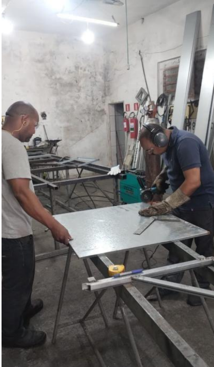
Figura 1 – Marcação nas chapas de aço para corte (imagem registrada durante a preparação das peças para estrutura do carro)
