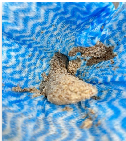
Figura 6 Resíduo pós-filtragem (celulose)
