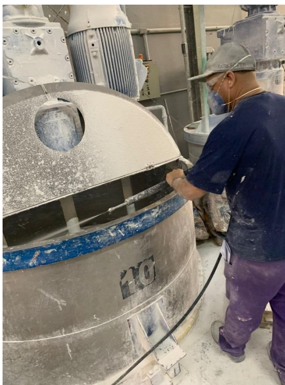
Fotografia 1 – Lavagem dos tanques de produção.
