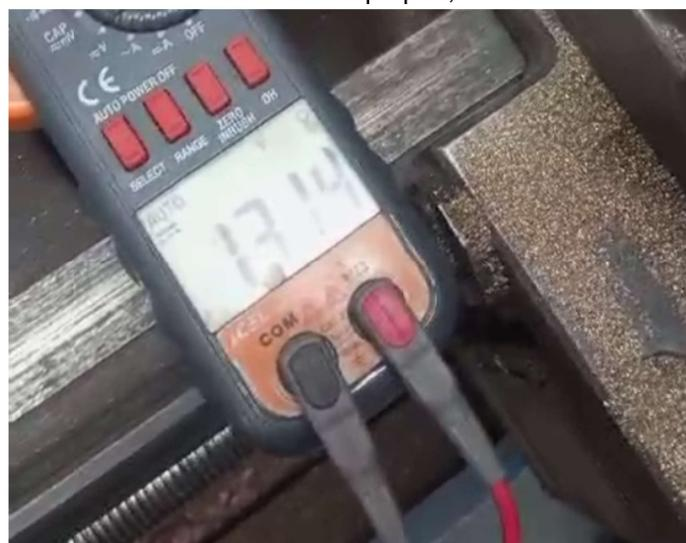
Por último foi realizado o teste com velocidade de 300 rpm, onde o dínamo foi capaz de gerar a tensão aproximada de 34 Volts e com esses valores foi possível identificar qual a rotação mínima necessária desejada.
