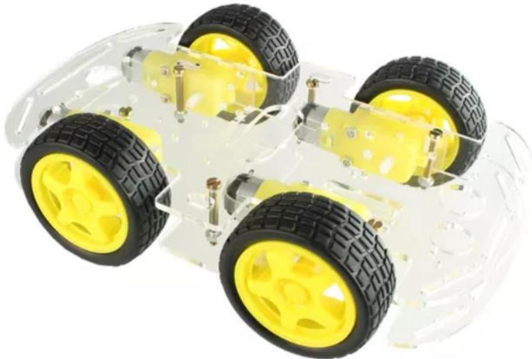
Figura 12 – Carrinho Arduino Robô 4wd 200rpm Acrílico 2,5mm/kit Chassis
