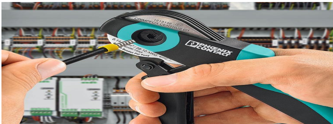
Figura 9- Processo de crimpagem com alicate manual.
