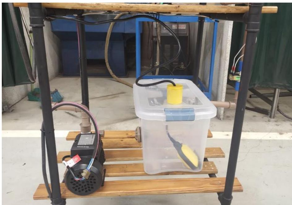
Figura 34 – Fixação da bomba e do reservatório de água.
