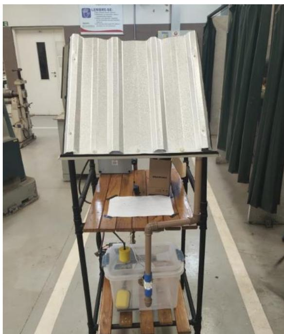
Figura 36 – Tubulação da calha até reservatório.
