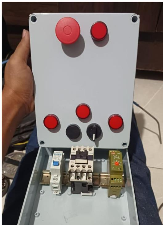
Figura 28 –Montagem dos acionamentos do comando e sinalização.
