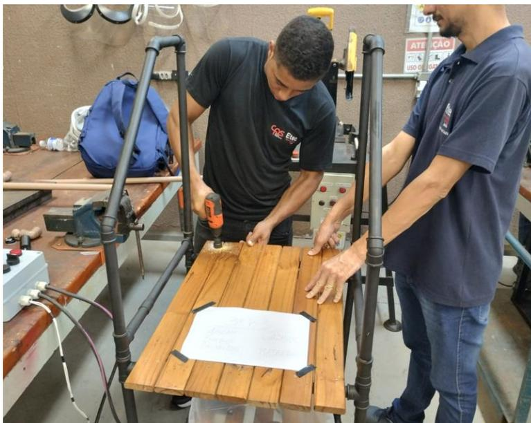
Figura 30 – Furação das passagens dos cabos e fixação
