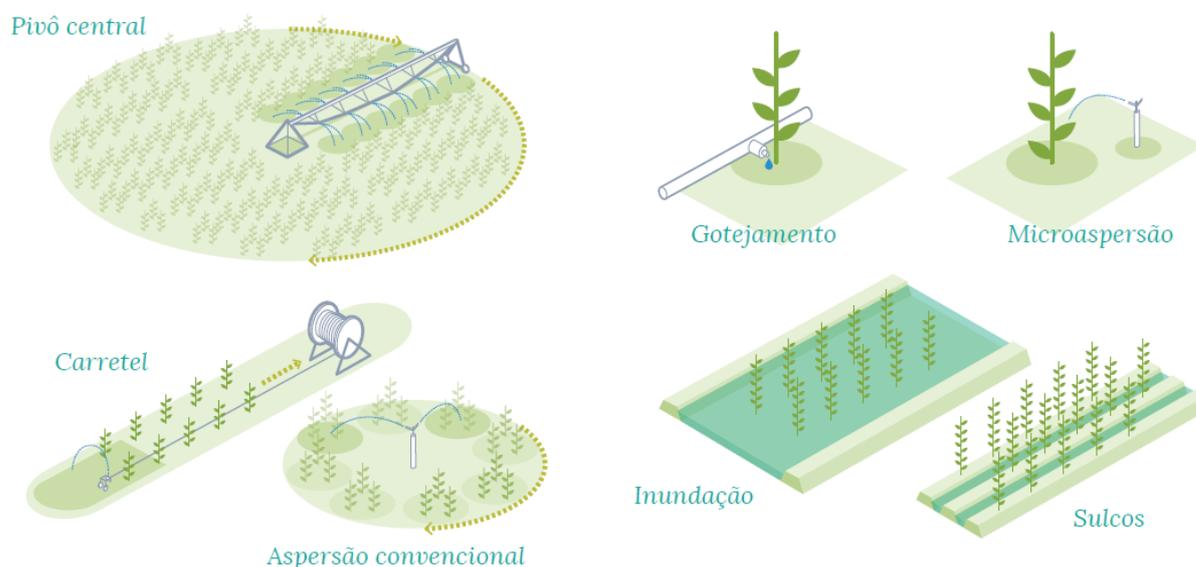
Figura 3 – Tipos e Sistema de Irrigação
