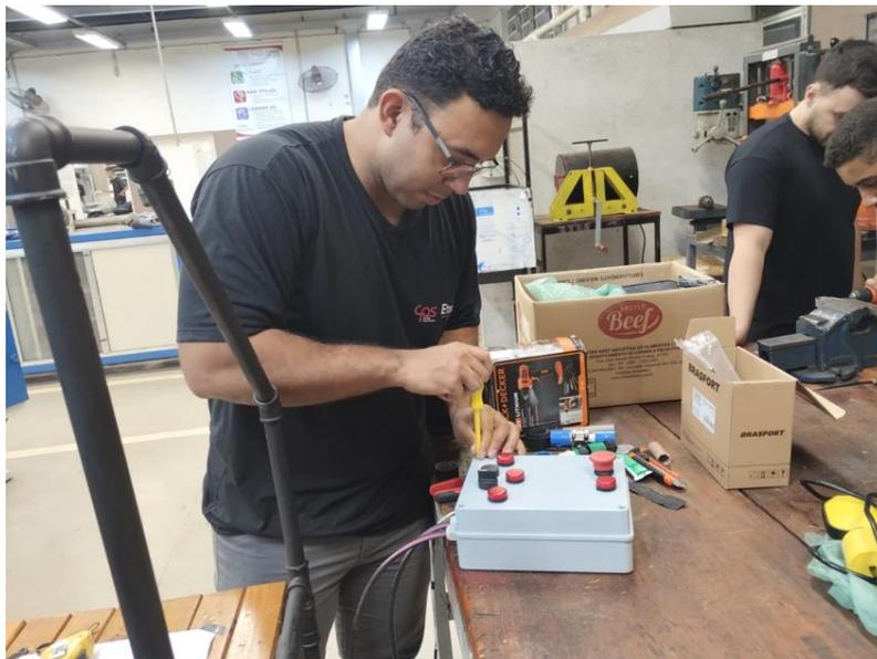
Figura 29 – Fechamento do Painel com ligações bomba e boia de nível
