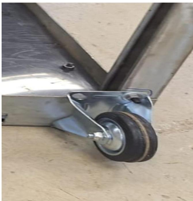
Figuras 30 e 31 – Furos e encaixe das rodas
