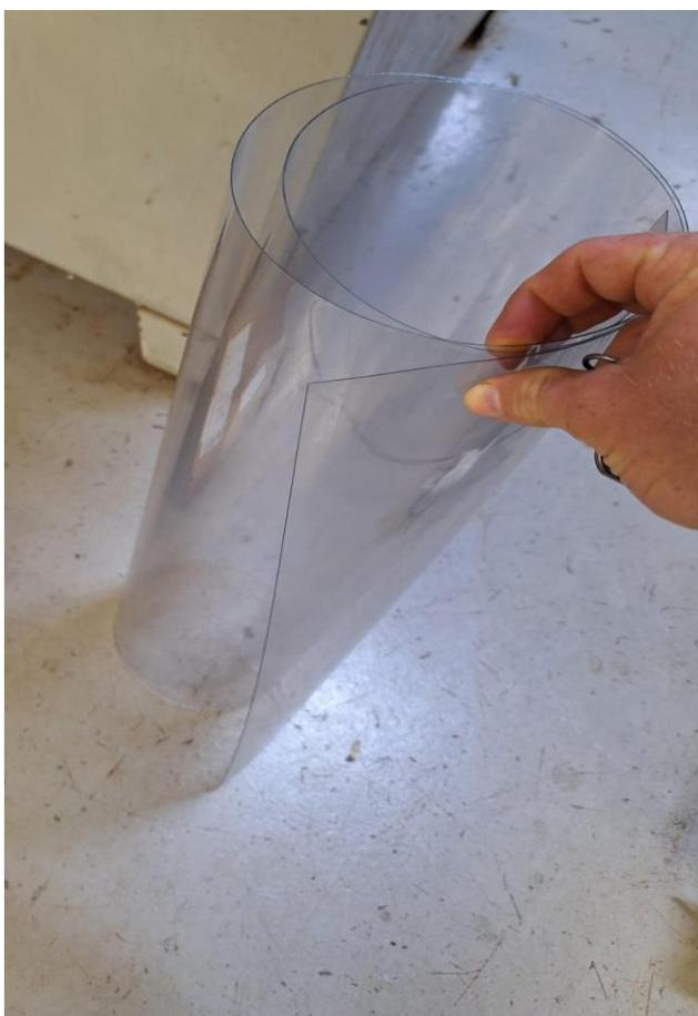
Figura 25 – Chapa de acetato transparente 62x120cm/0,7cm espessura
