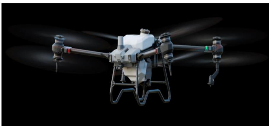
Figura 9 – Agras T40, Drone de aplicação agrícola
