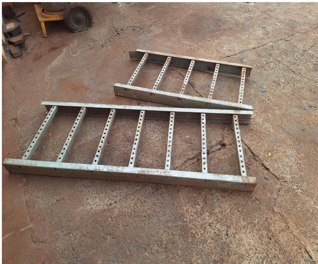
Figura 27 – Eletrocalha aço galvanizado
