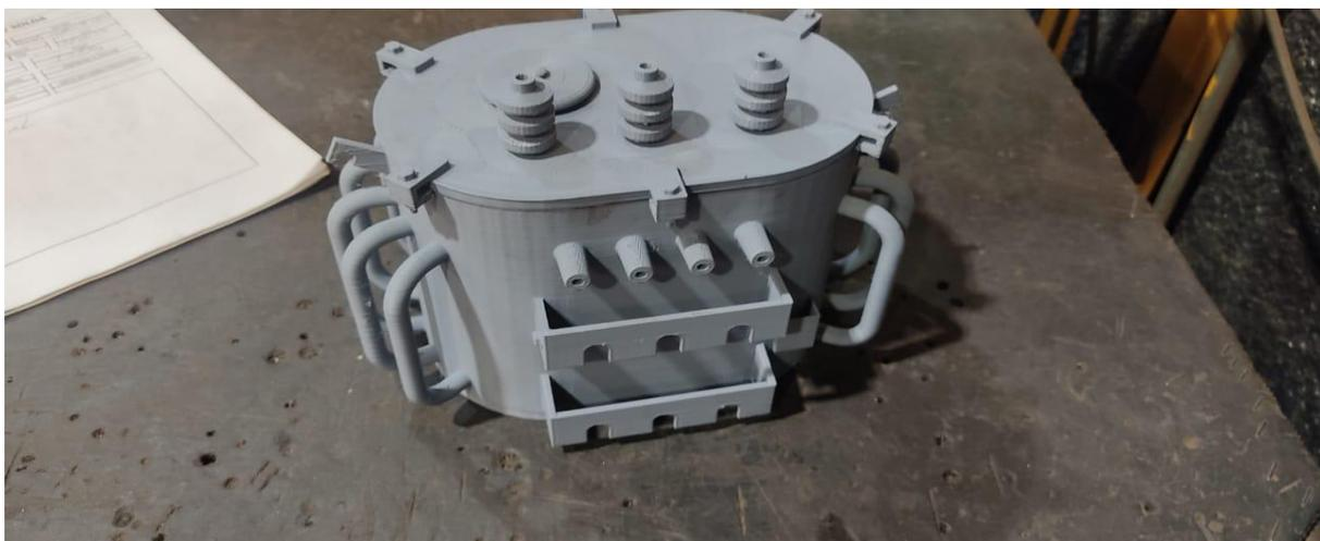
Figura 24: Transformador fabricado em impressora 3D
