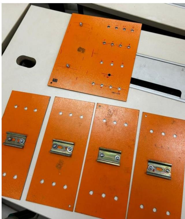
Figura 6 – Placas prontas após o processo de furação
