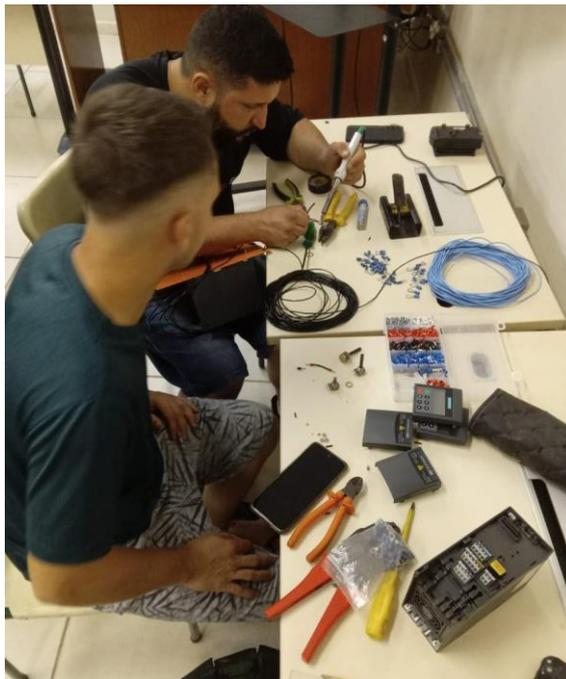
Figura 14 – Solda do potenciômetro e passagem de cabo nas placas
