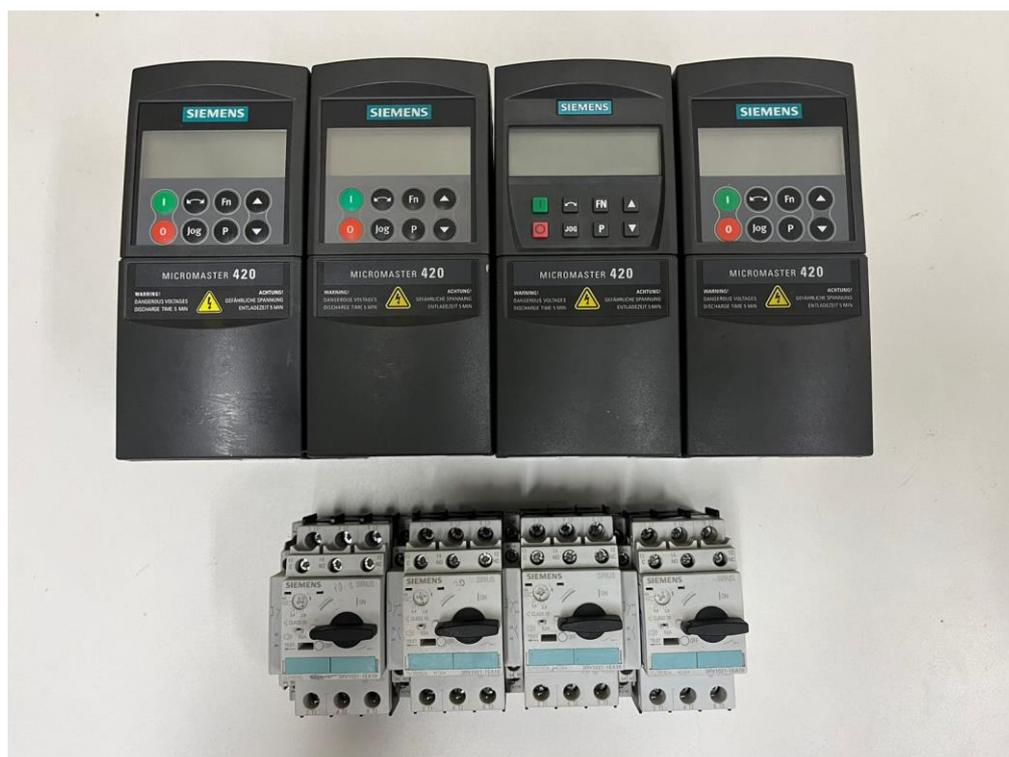
Figura 3 – Principais materiais utilizados, quatro inversores e quatro disjuntores.
