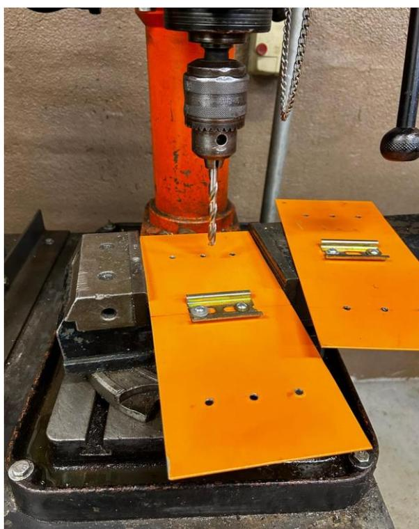
Figura 8 – Auxilio da furadeira de bancada para furação
