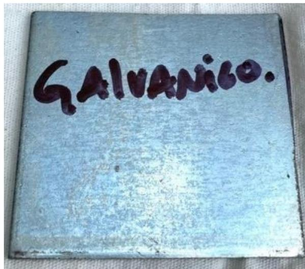
**Figura 6** - Placa de aço galvanizado pós-corrosão.
