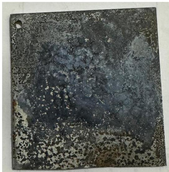
Após sete dias de exposição contínua a uma solução salina com 3,5% de NaCl, observou-se a ocorrência de corrosão em todas as amostras metálicas avaliadas, embora com comportamentos
