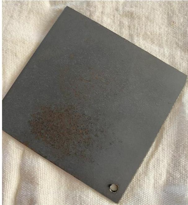
**Figura 4** - Placa com oxidação negra pré-corrosão.
