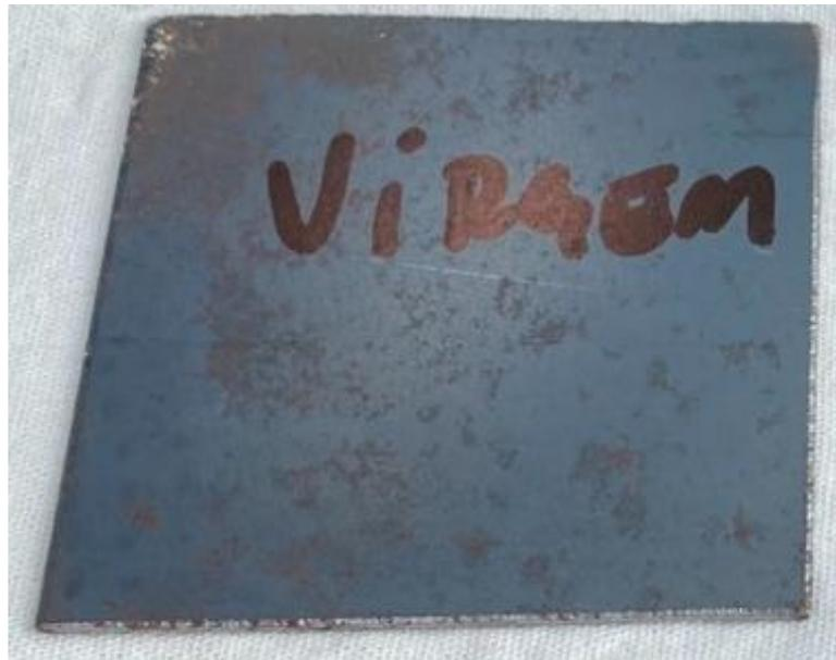
**Figura 2** - Placa de aço virgem pós-corrosão.
