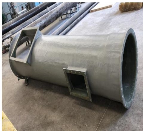
Figura 8 – Tubulações de ar de fibra de vidro.
