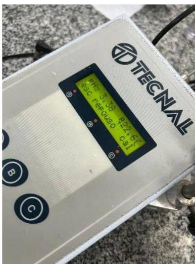
Posteriormente adicionou-se o reagente químico Hidróxido de cálcio até atingir o pH de 9,0, em seguida adicionou-se ácido fosfórico para derrubar o pH de 9,0 para 5,12, esse processo tem como objetivo obter-se uma solução mais equilibrada para interromper o processo de fermentação, acabar com os micro-organismos e melhorar o sabor final.
