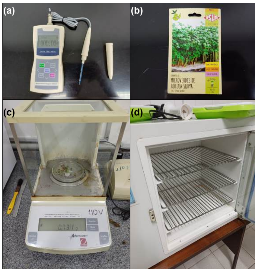
Figura 2 – Equipamentos e insumo utilizados no experimento, gaussímetro (a); semente de rúcula (b); balança semi-analítica (c) e estufa (d)
