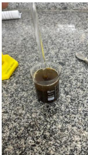
**Figura 06.** Preparo de solução contendo, Sulfato de Potássio, Cloreto de Sódio Fosfato de Amônio e Mel B
