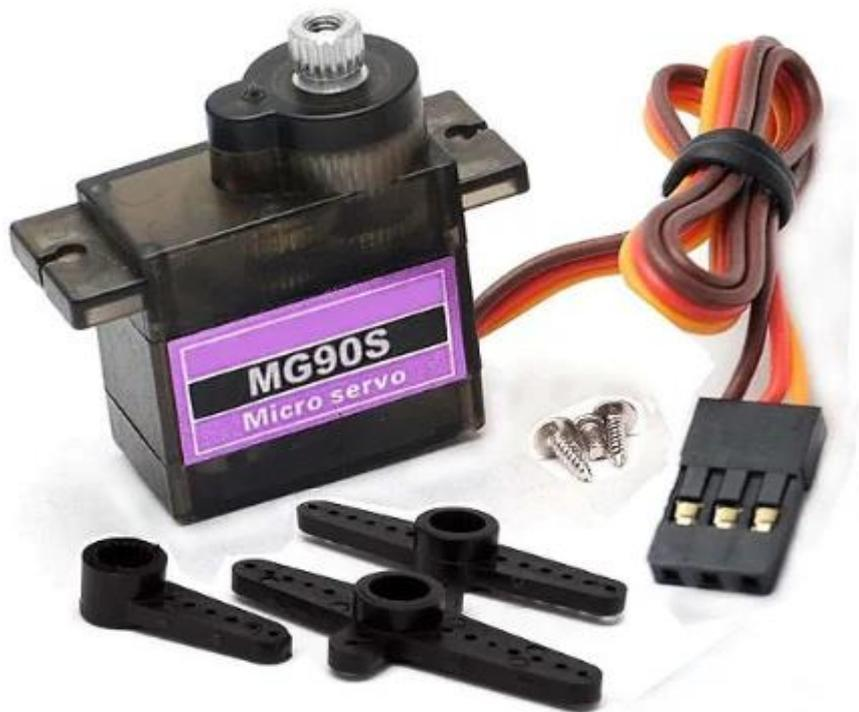
O servomotor é um atuador eletromecânico, que apresenta movimento proporcional a um comando, como dispositivos de malha fechada, ou seja: recebem um sinal de controle eletrônico; que verifica a posição atual para controlar o seu movimento indo para a posição desejada com velocidade monitorada externamente sob feedback de um dispositivo denominado taco ou sensor de efeito Hall ou encoder, dependendo do tipo de servomotor e aplicação
