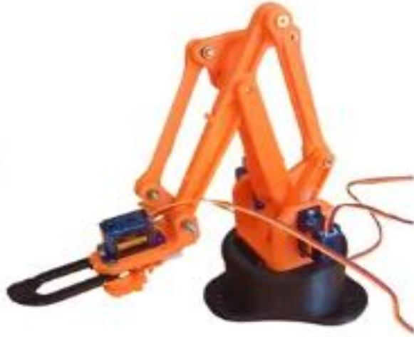
Um braço robótico articulado é um dispositivo mecânico projetado para simular os movimentos de um braço humano, com múltiplos graus de liberdade. Ele é composto por uma série de segmentos (ou elos) conectados por juntas móveis (ou articulações), que podem ser rotacionais ou lineares, permitindo movimentações precisas em diferentes direções.
