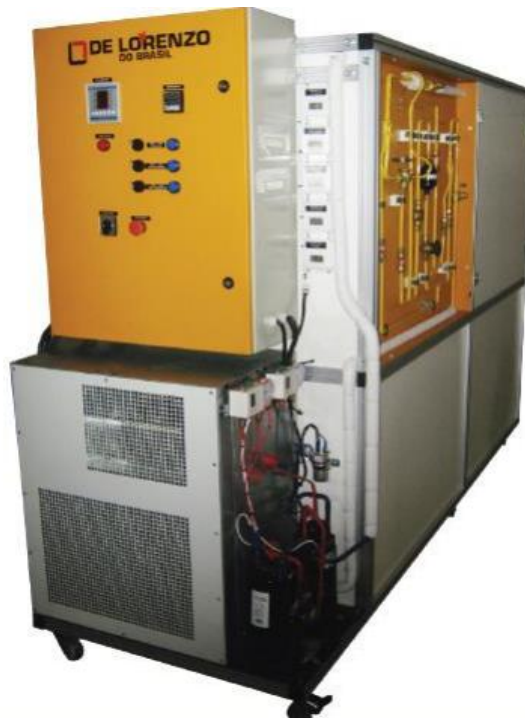
Figura 1 - Estação de simulação ar-condicionado
