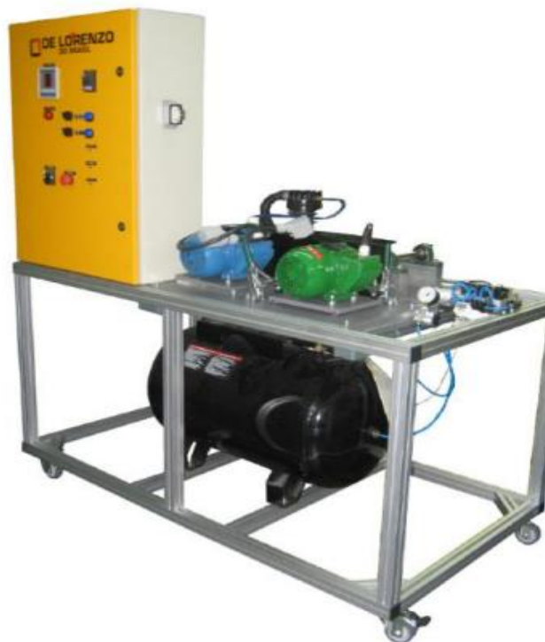
Figura 3 - Estação de simulação do compressor de ar
