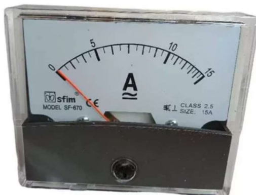
Figura 10 – Amperímetro Analógico 15ª AC / DC SF670
