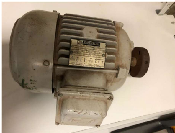
Figura 6 - Motor de Indução Trifásico tipo Gaiola de Esquilo EBERLE
