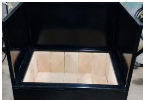
Figura 33 - Montagem dos tijolos refratários.
