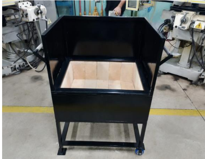
Figura 34 – Montagem da moldura para o travamento.
