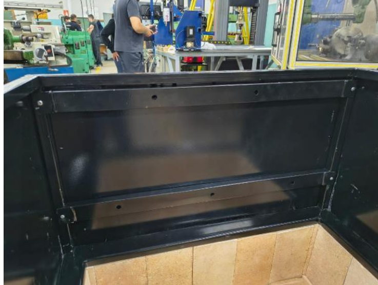
Figura 36 – Fixação dos tubos 40x20
