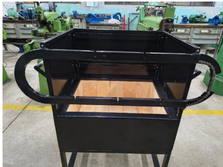
Figura 37 – Fixação da pista de corrente.
