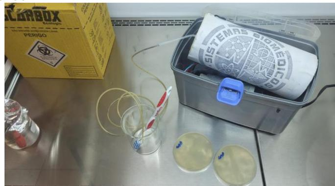
Figura 5 Gerador de ozônio com desinfecção das cerdas da escova de dente em água contaminado *S. epidermidis*
