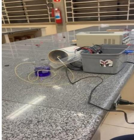
Figura 5 -Gerador de ozônio experimental (>2,8mg/L)
