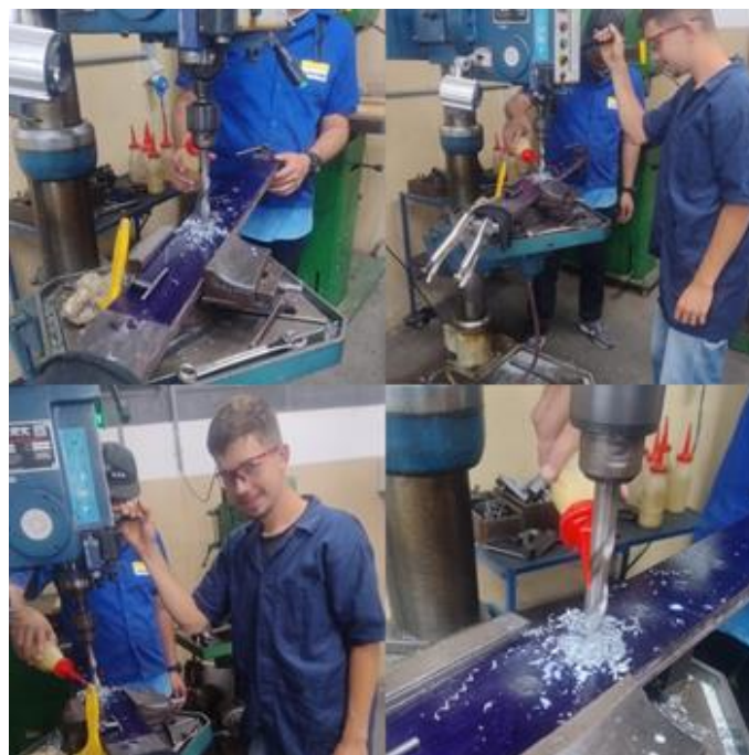
Figuras 4 - Furação para fixação de pinos e parafusos.
