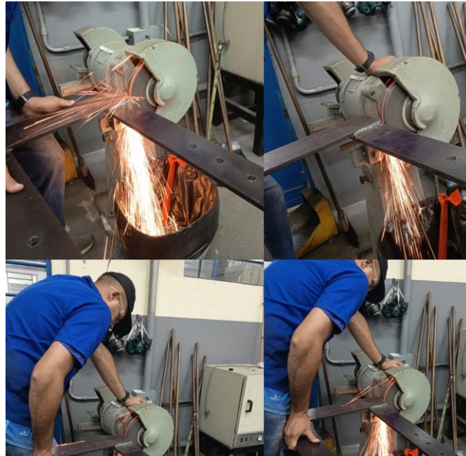
Figura 3 - Desbaste e acabamento.
