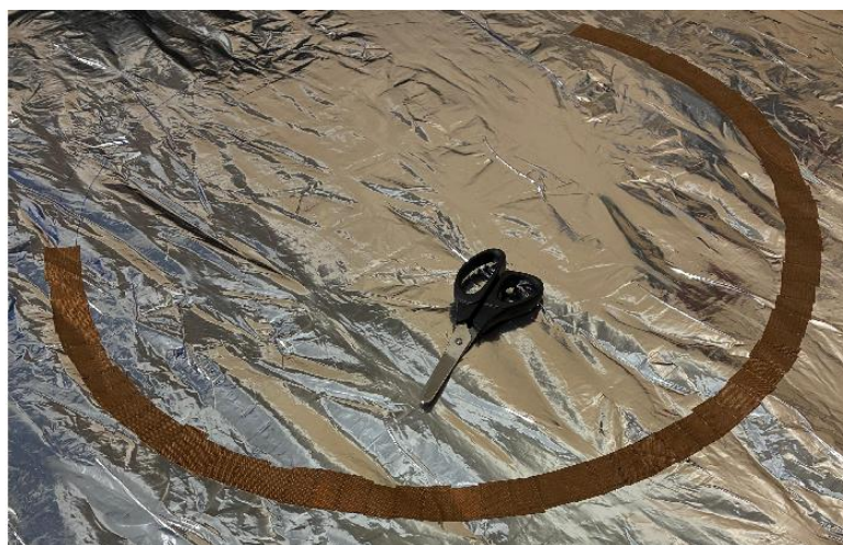
Figura 7 – Fita térmica onde fica a resistência elétrica.
