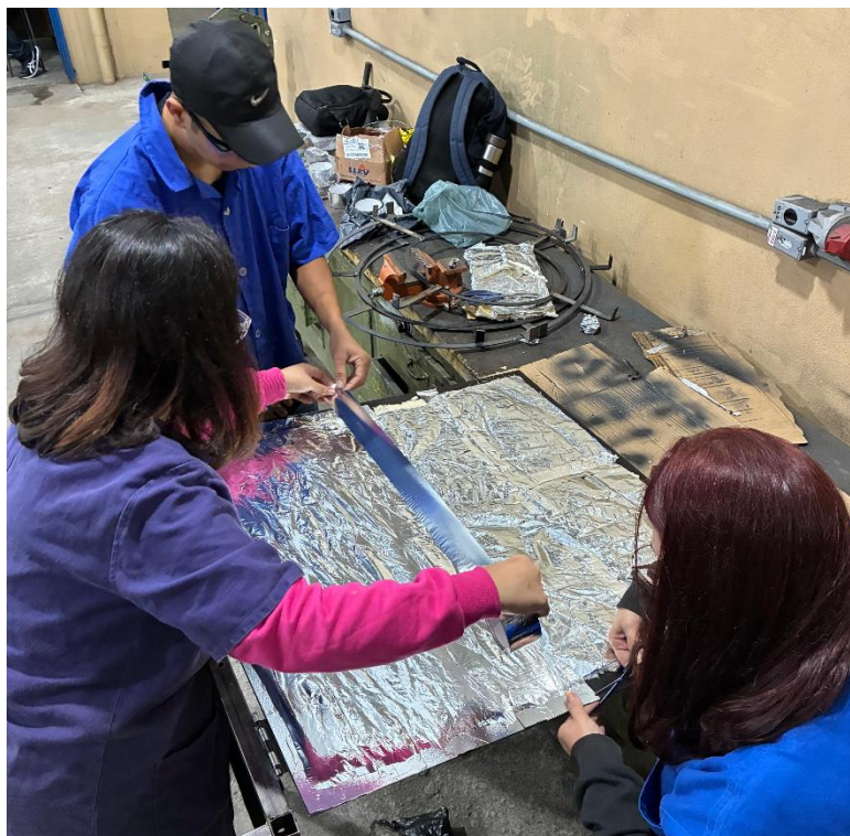
Figura 6 – Forração da tampa com manta térmica.
