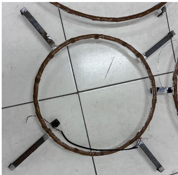
Figura 8 – Fita térmica fixadas nos aros.
