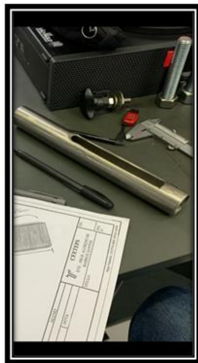
Figura 3 – Tubo de inox com o rasgo.
