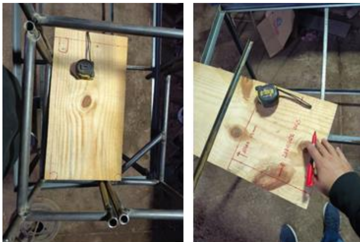
Figura 7 – Marcação do assento.
