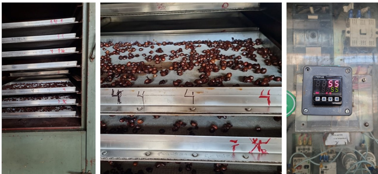
Figura 4 – Polpa de café em secador de bandejas com temperatura controlada.
