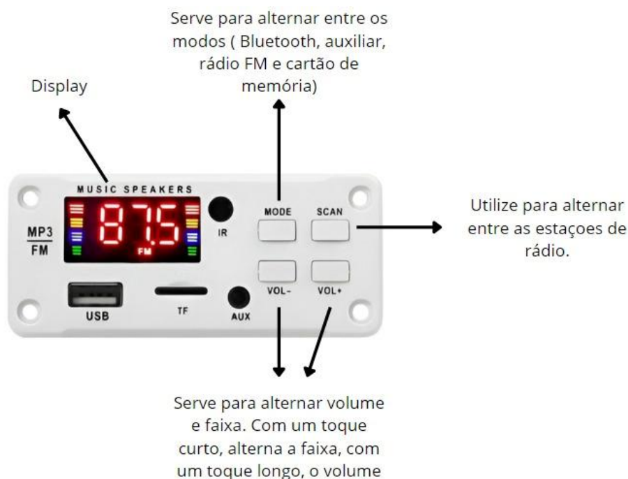
FIGURA 2: Esquema de funcionamento dos botões do painel.
