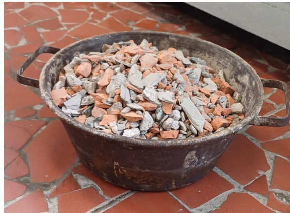
Figura 4 – Tacho de material reciclável cerâmico com reboco
