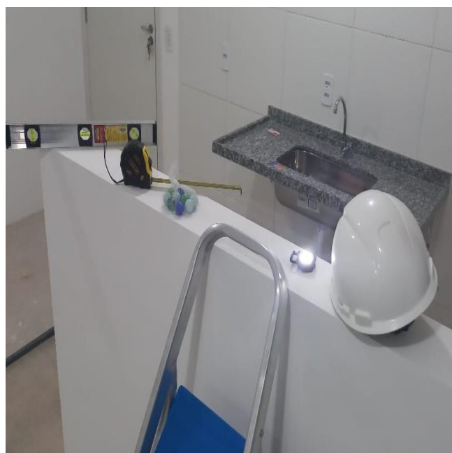
Figura-9 ferramentas usadas para efetuar a vistoria técnica. Nível de bolha, trena, bolinha, lanterna, escada e capacete.
