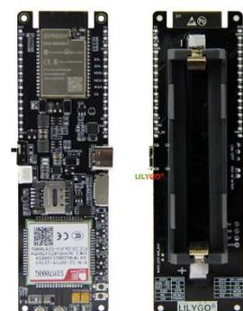
*Figura 3: Placa LILYGO T-SIM7000G ESP32*
