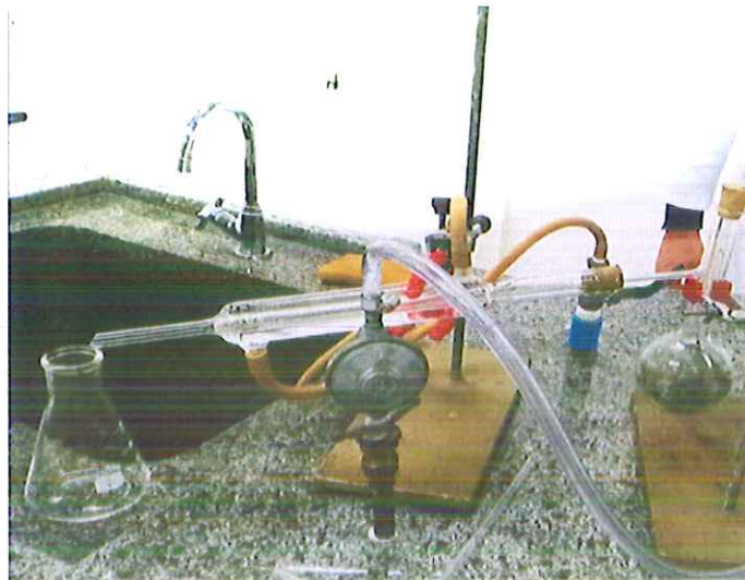
Figura 7: vapor misturado com o óleo passa dentro do condensador. Acervo pessoal 08/2014.
