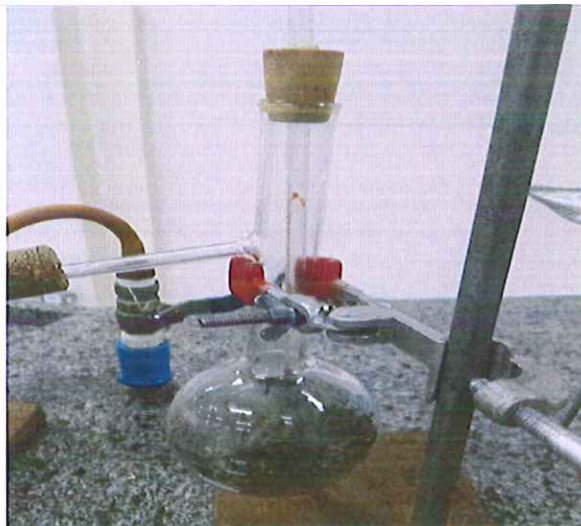
Figura 6: Balão de Destilação contendo a Alfavaca picada. Acervo pessoal 08/2014.
