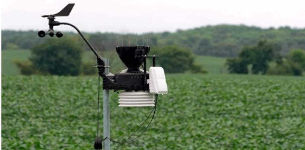
**Figura 3** – Sensor de chuva (pluviômetro)
