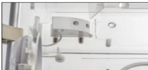
**Figura 11. Sensor de Umidade**
