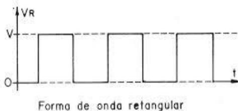
Figura 3: Imagem de uma forma de onda do equipamento FES. Fonte:
