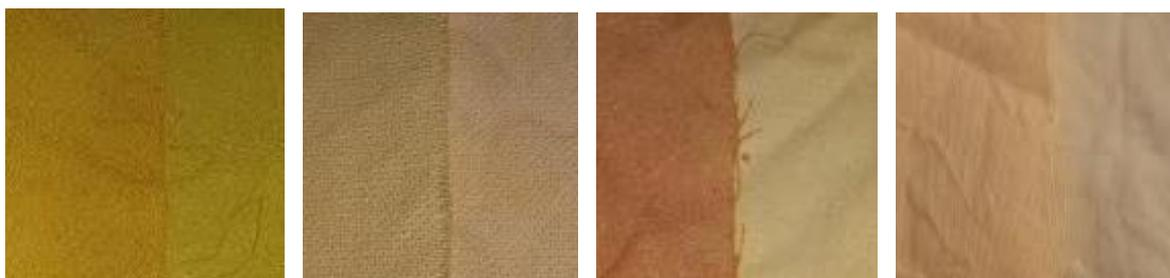
Figura 17 - Alteração da cor do tecido após lavagem urucum – água
