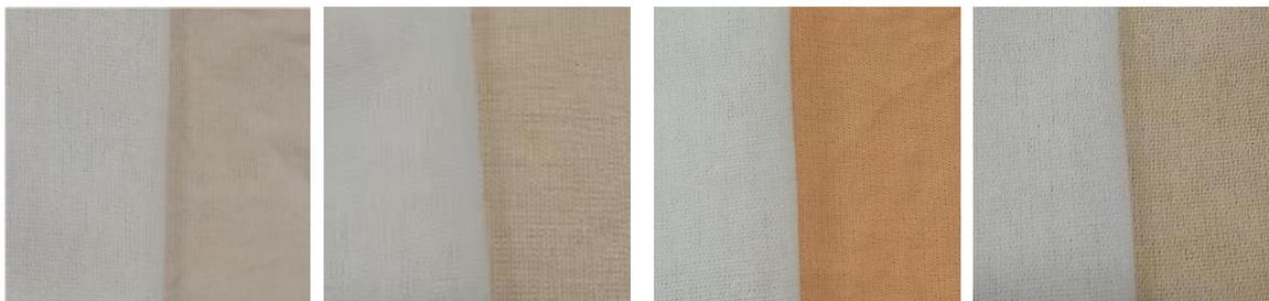
Figura 19 - Transferência de cor para o tecido testemunha do corante urucum - sabão comercial.
