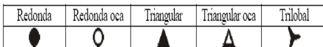
Figura 13: Formatos da seção transversal de fibras
