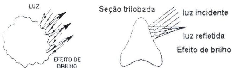
Figura 17: Efeitos Ópticos produzidos pelo Tipo de Seção Transversal
