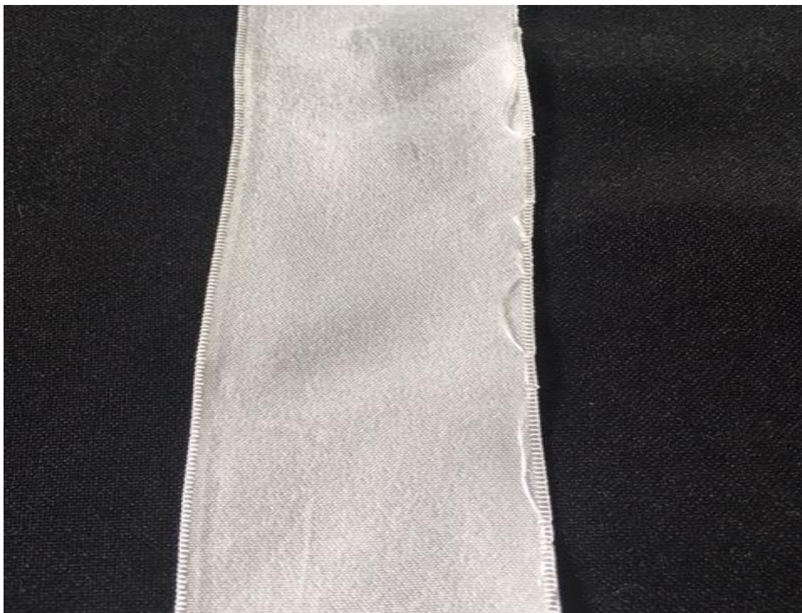
Figura 27: Verso da fita com fio solto
