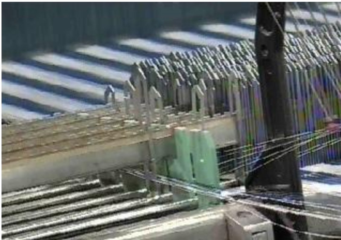
Figura 22: Lamelas do guarda urdume Fonte: Site Ebah
